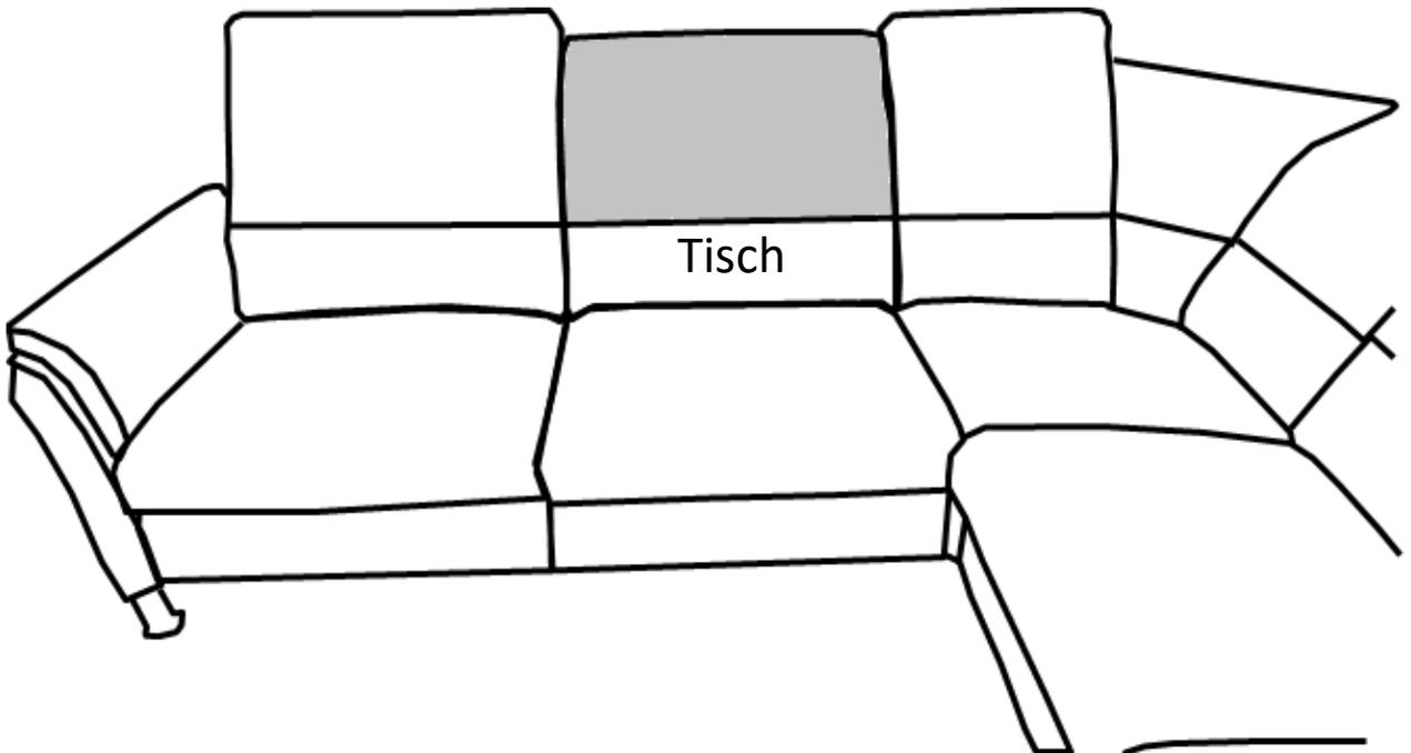
In Verbindung mit Tischfunktion wird immer ein Klemmbeschlag verwendet, bei offenem Kopfteil ist der Rücken um bis ca. 8 cm niedriger als der Standardtyp.
